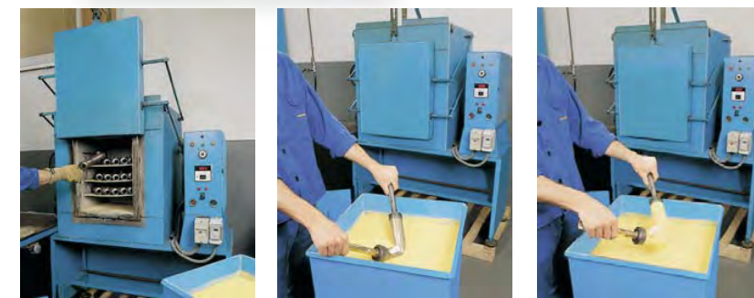
REVESTIMIENTO PLASTICO ANTICORROSIVO
